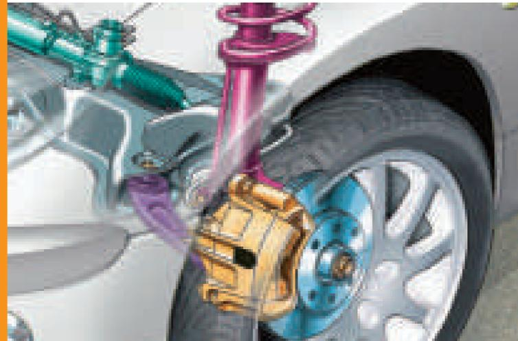
Perfekte Straßenlage dank MacPherson-Vorderachse mit Querstabilisator. Die Hinterachse mit Längslenkern verfügt über spielfreie Gelenke. Der PEUGEOT 206 CC ist mit einem vorbildlichen Bremssystem ausgestattet: ABS mit elektronischem Bremskraftverteiler, Notbremsassistent und vier Scheibenbremsen, vorn innenbelüftet.
