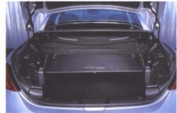
*Der quaderförmige Kofferraum mit Standard-Reserverad bietet ein Ladevolumen von 350 l (Coupé) bzw. 204 l (Cabriolet) nach VDA-Norm.*
