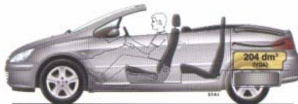
Der Innenraum musste für bis zu vier Insassen optimiert und gleichzeitig das Dach so platzsparend konzipiert werden, dass im offenen Zustand sämtliche Dachkomponenten zusammengefaltet im Kofferraum verschwinden. Außerdem wurde die Fahrgastzelle im hinteren Bereich überarbeitet,
