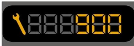
5 Sekunden nach dem Einschalten der Zündung nimmt der Kilometerzähler seine normale Funktion wieder auf, während der Wartungsschlüssel erleuchtet bleibt.
