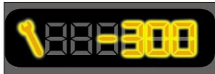
5 Sekunden nach dem Einschalten der Zündung nimmt der Kilometerzähler seine normale Funktion wieder auf, während der Wartungsschlüssel erleuchtet bleibt. In der Anzeige erscheinen der Gesamtkilometerstand oder der Tageskilometerstand.
